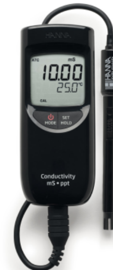
Sonde de conductivité avec connexion Quick DIN avec dispositif de détrompage
